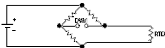
Figure 40 - Mesure par pont en extension
