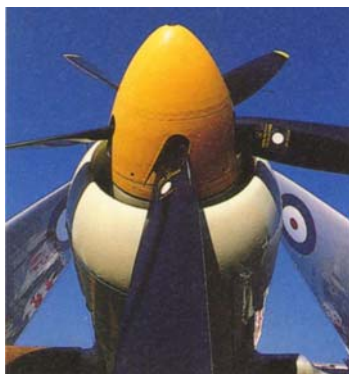
Hélice à 5 pales en composite
