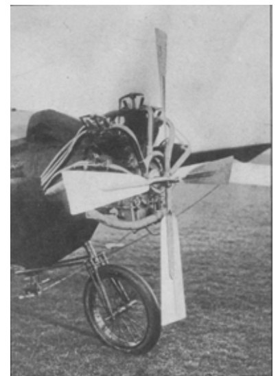
Moteur R.E.P. (Esnault-Pelterie) de 60 CV (1908). 7 cylindres en éventail, monté sur un monoplan R.E.P.
